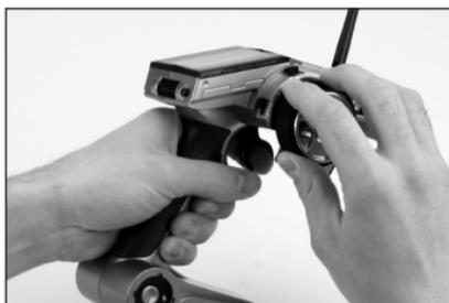
4. Seguire le procedure specifiche per il trasmettitore per iniziare la modalità di collegamento; il sistema si conatterà entro 15 secondi. Dopo la connessione, il LED sul ricevitore rimarrà fisso, indicando che il sistema è connesso.
