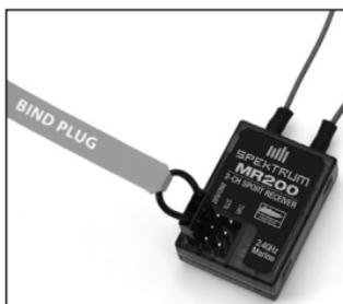
2. Alimentez le récepteur par n'importe quel port libre. La DEL située sur le récepteur doit clignoter, indiquant ainsi qu'il est en mode affectation et prêt à être affecté à l'émetteur.
