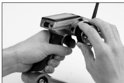
4. Folgen Sie bitte den senderspezifischen Anweisungen zum Binden. Das System wird sich innerhalb von 15 Sekunden binden. Ist das System verbunden, hört die LED auf zu blinken und leuchtet Rot.
