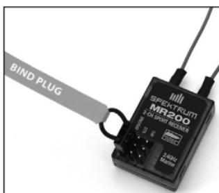
2. Alimentare il ricevitore tramite una qualsiasi porta aperta. Il LED sul ricevitore dovrebbe lampeggiare indicando che il ricevitore è in modalità di connessione ed è pronto per essere connesso al trasmettitore.
