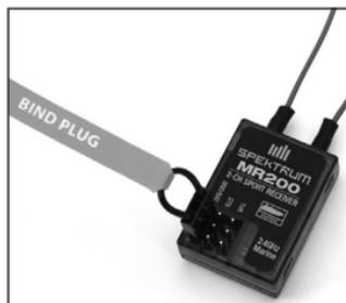
2. Schließen Sie eine Empfängerstromversorgung an. Hierzu können Sie einen beliebigen Servoanschluß (STR oder THR) nehmen und der Empfänger ist bereit zum binden.
