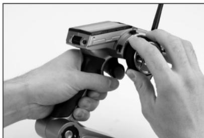
4. Respectez les procédures spécifiques à votre émetteur pour aller en mode affectation. Le système se connectera dans les 15 secondes. Une fois la connexion établie, la DEL du récepteur reste allumée, indiquant que le système est connecté.
